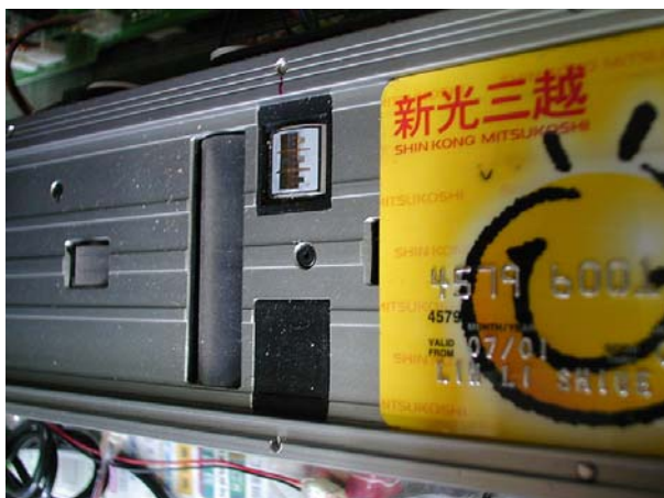
圖 4. 磁卡讀取機構與 3 軌讀取頭。
