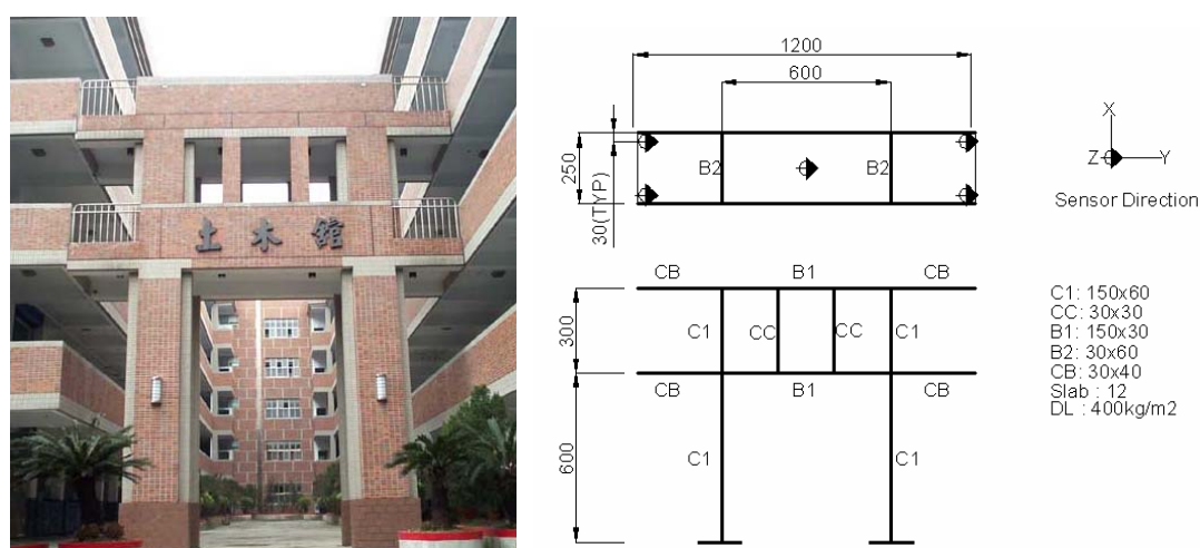
圖 1 土木館連絡空橋現況、結構尺寸與測點規劃
